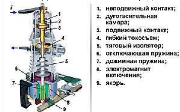
Рисунок 2 – Принципиальная схема вакуумного выключателя
