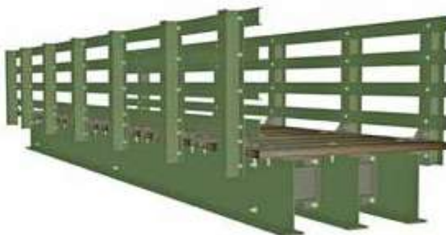
Рисунок 2 – Настил моста из стеклопластика
