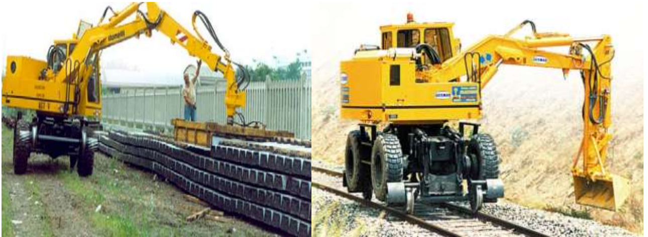
Рисунок 2 – Использование модульной техники на комбинированном ходу при выполнении путевых работ
